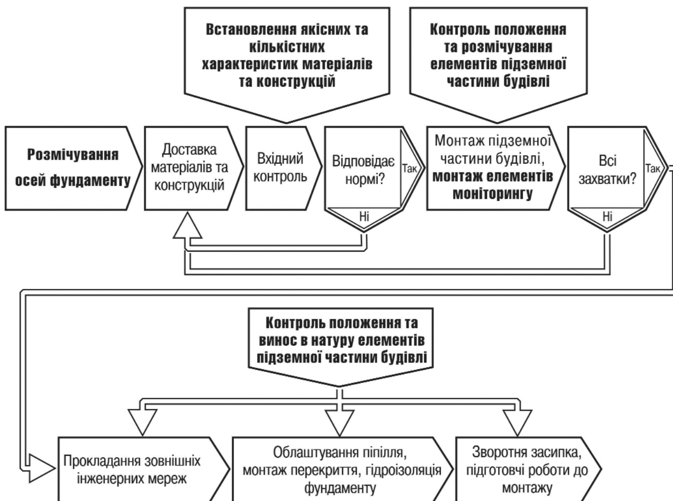
Рис. 3. Будівельно-вимірювальні роботи в період нульового циклу будівництва
