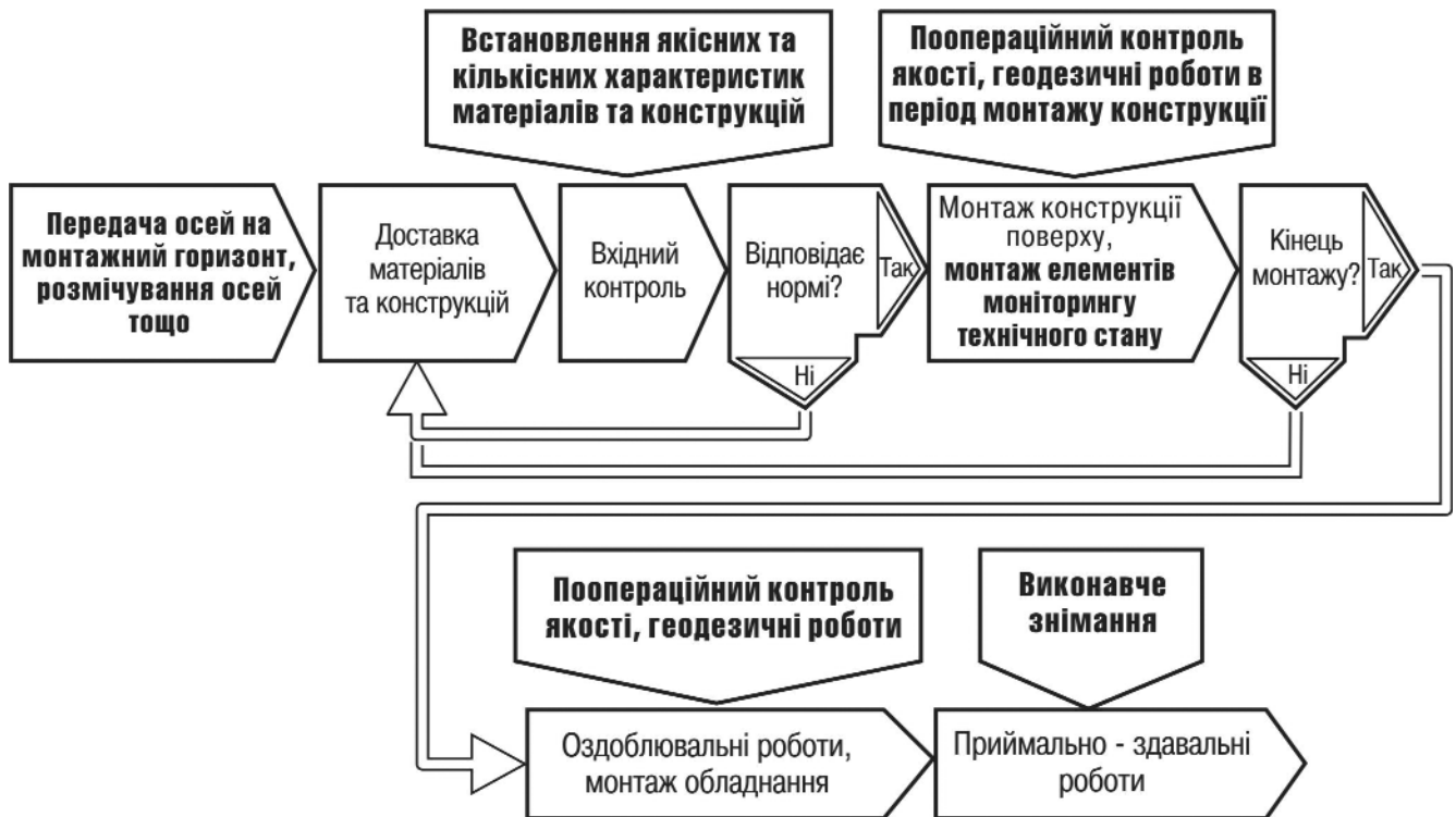
Рис. 4. Будівельно-вимірвальні роботи в період зведення об'єкта будівництва
