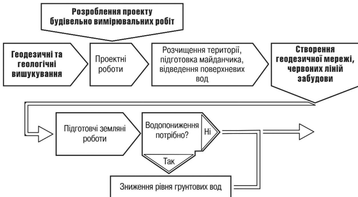
Рис. 2. Будівельно-вимірювальні роботи в період передпроектних робіт, проектування та підготовчого періоду
