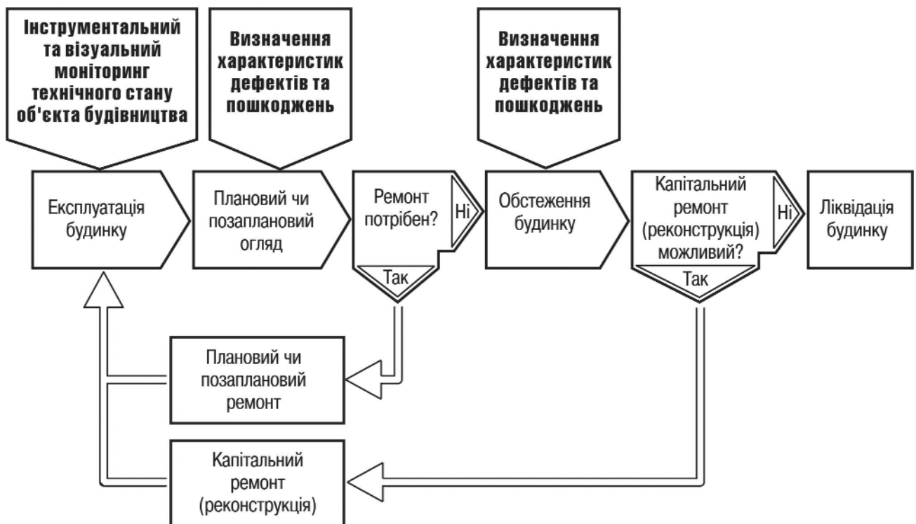
Рис. 5. Будівельно-вимірвальні роботи в період експлуатації об'єкта будівництва
